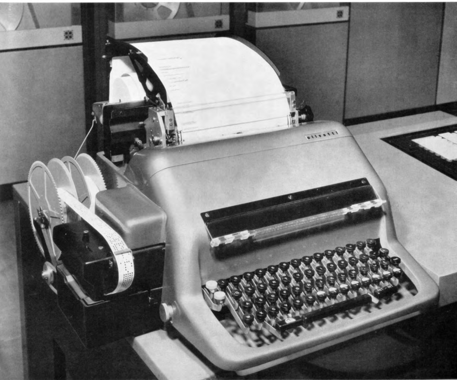
La macchina da scrivere dotata di perforatore di nastro di carta collegata all'elaboratore elettronico Elea 6001
