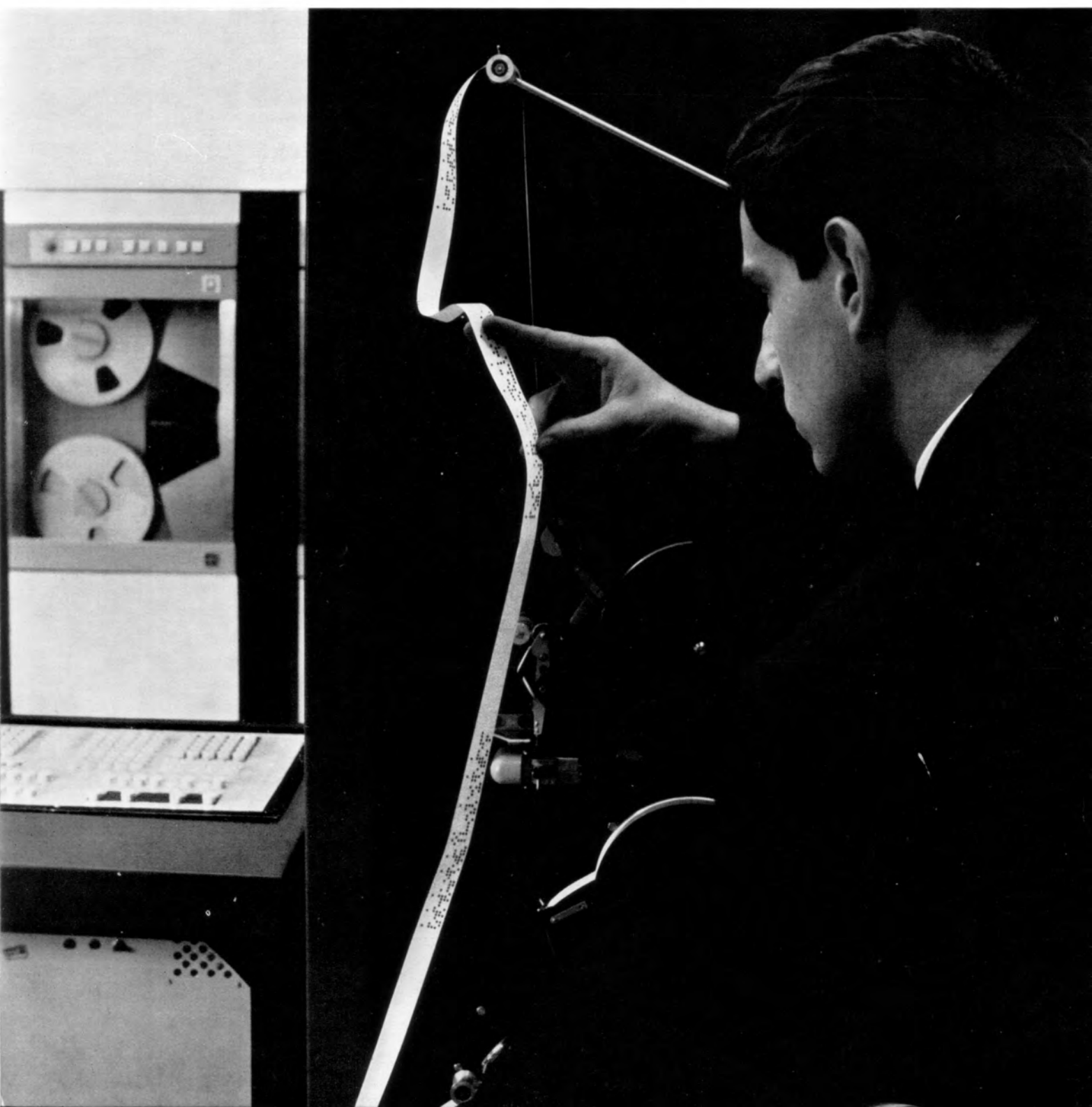
Il fotolettore veloce di nastro perforato, collegato all'Elaboratore Elettronico Elea 6001
