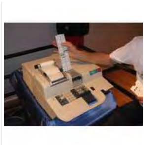
Per velocizzare le operazioni la Programma 101 è stata programmata con istruzioni memorizzate su tessere magnetiche, antesignane dei floppy disk
